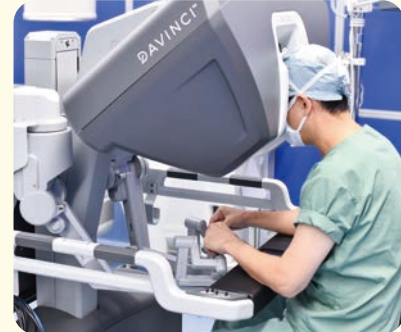
執刀医は手術部位を高倍率画像で確認、コントローラーで内視鏡・メス・鉗子を操作します
